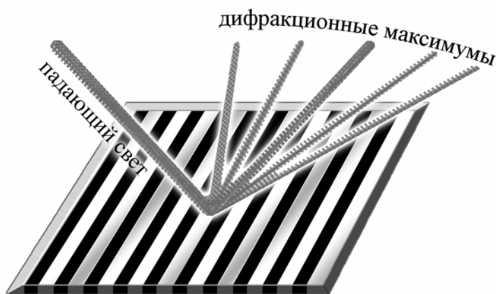
Рис. 3. Расщепление света за счет дифракционной решетки.
