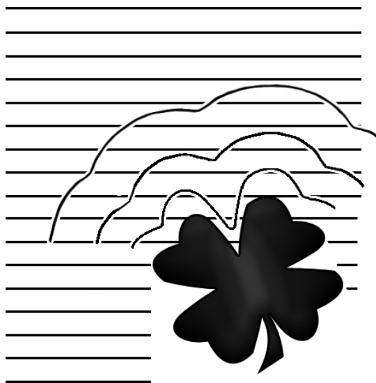
Рис. 1. Фронт плоской световой волны до и после отражения от предмета.
